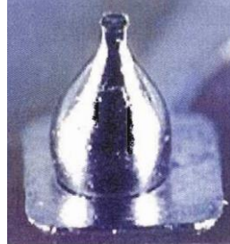
Непропай/неполное смачивание контактных площадок
